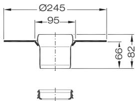
**Aufsatzelement mit Muffe**
